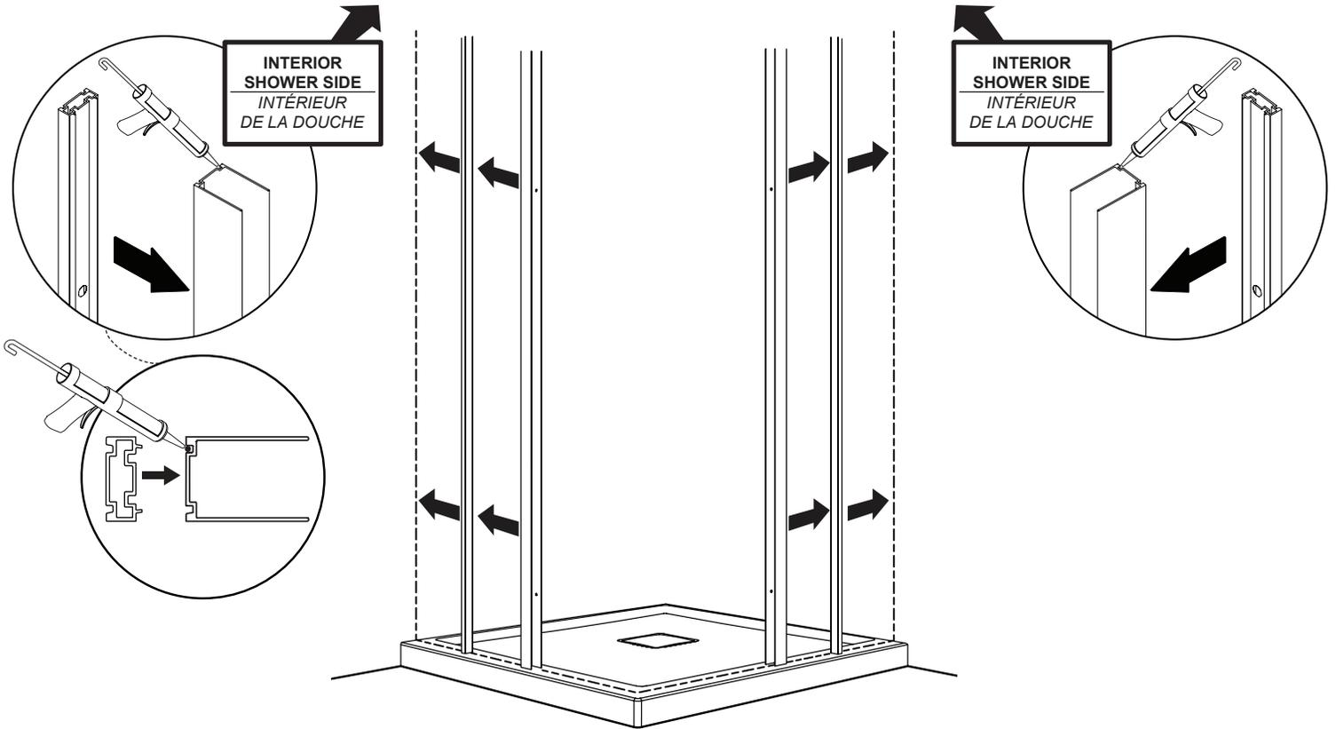
**5** **INSTALL THE WALL JAMBS / INSTALLER LES JAMBAGES**
